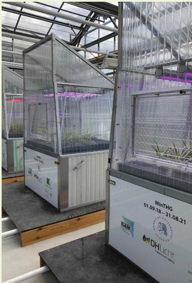
**Abb. 1: Einsatz der wassergekühlten LED-LE in den Pflanzenküvetten**
