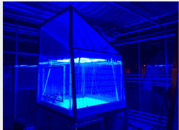
Abb. 2: LED-LE mit monochromatischem rotem und blauem Licht Fig. 2: LED-LE with monochromatic red and blue light.
